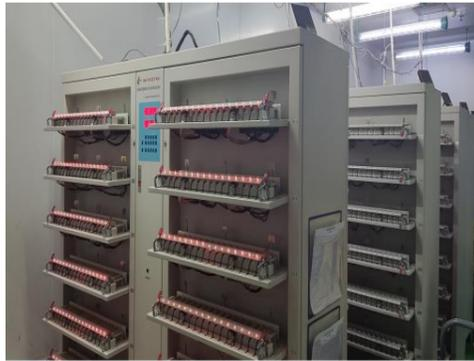
能量回馈型电芯老化设备
